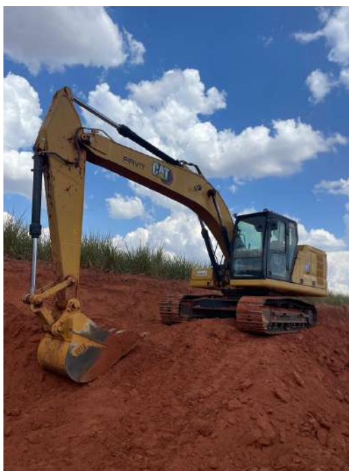
Figura 02 – Escavadeira Hidráulica CATERPILLAR 320GC
